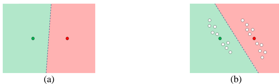
Figure 2 : apprentissage supervisé (a) et semi-supervisé (b). Les points représentent les données servant à l'apprentissage : un point vert correspond à une cible connue (de valeur "vert"), un point rouge correspond à une cible connue (de valeur "rouge") et un point blanc correspond à une cible inconnue. Le trait bleu discontinu représente le modèle obtenu. La figure a) présente le cas de l'apprentissage supervisé et la figure b) présente le cas de l'apprentissage semi-supervisé.
